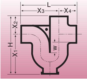
При DN 50 – DN 150 инспекционное отверстие внизу;
