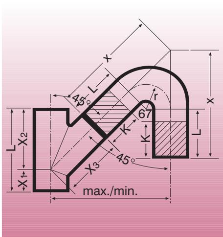
**Комбинации из тройников SML 45° и колен SML 135° для обходных трубопроводов**
