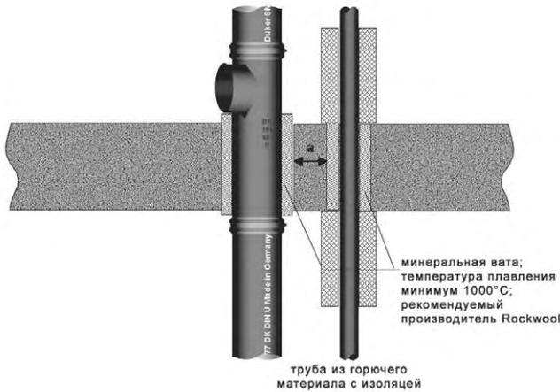
Использование Düker EK Fix или каких либо других соединений для монтажа пластиковых труб рядом с линией разрыва не допустима.
