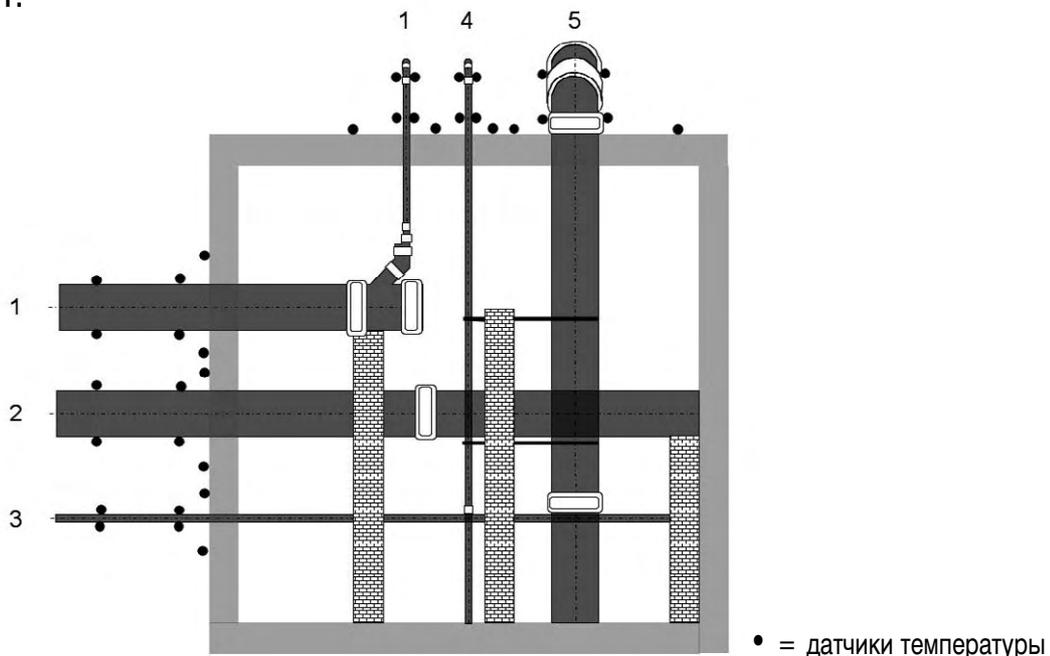
Согласно действующим итальянским правилам, сопротивляемость трубопровода 1 пожару попадает под инспекцию Düker (Германия) в соответствии с классификацией: **REI 63 RE 180.**
