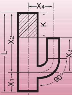
**SML параллельный тройник DIN 19522-100x70 P**
