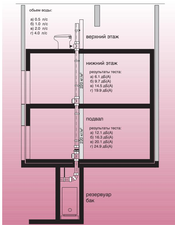
По результатам последнего теста, проведенного в Нидерландах, трубы Düker достигли лучших результатов, чем другие канализационные трубы из иных материалов, даже изготовленные из специального звукоизолирующего пластика. Стандарты шумоизоляции 30 dB (A) в помещениях. Требуется шумоизоляция по немецким стандартам.
