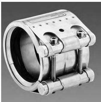
Connect-F: не устойчив к осевым нагрузкам; выдерживает давление до 10 бар при соответствующем креплении трубы, которое гасит осевые нагрузки.
