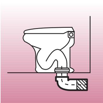
1. Стоящий WC со скрытым вертикальным выпуском. Подключение WC к чугунному угловому соединителю при помощи пластикового WC соединителя.
